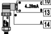
Per segnali normalizzati in corrente 0/4..20 mA **con sensore a tre fili.**
