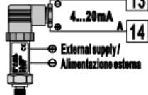
Per segnali normalizzati in corrente 0/4..20 mA **con sensore ad alimentazione esterna.**
