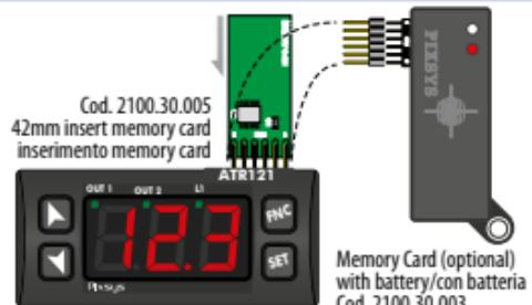
È possibile duplicare parametri e setpoint da un regolatore ad un altro mediante l'uso della Memory Card.
