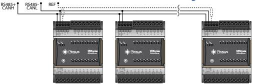
Schaltplan für den Anschluss mehrerer MCM260X an eine RS485-Leitung oder ein CAN-Netzwerk.
