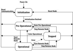
Die NMT-Serviceelemente ermöglichen die Zustandsveränderung unter jeder Bedingung. Die NMT-Nachrichten bestehen aus einem CAN-Header (COB-ID = 0) und 2 Datenbytes. Ein Byte enthält den angeforderten Service (NMT command specifier), das andere enthält den Node-ID (0 für Broadcast-Modus). In einem CANopen-Netzwerk gibt es immer nur einen NMT-Master. Er überbringt die NMT-Nachrichten und hat die Kontrolle über die Initialisierungsprozesse.
