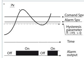
Allarme di deviazione superiore valore di setpoint allarme minore di "0" e valore di isteresi maggiore di "0" (Par. R.I.HY Index 0x3000 Sub-Index 58 > 0).
