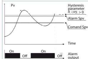
Allarme di deviazione inferiore valore di setpoint allarme minore di "0" e valore di isteresi maggiore di "0" (Par. R.I.HY Index 0x3000 Sub-Index 58 > 0). NB: con isteresi minore di "0" ( $R.I.HY < 0$ ) la linea tratteggiata si sposta sotto il Setpoint di allarme.
