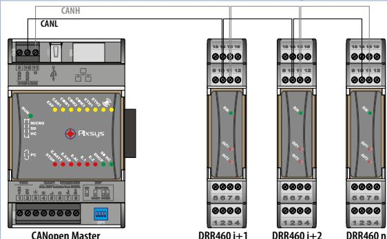
Una rete in CANopen prevede una resistenza di fine linea di  $120\ \Omega$ . Nel caso di una connessione di più moduli in cascata, alla fine della linea, è necessario inserirla nell'ultimo DRR460 della rete.
