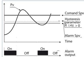
Allarme di deviazione inferiore valore di setpoint allarme maggiore di "0" e valore di isteresi maggiore di "0" (Par. R.I.HY Index 0x3000 Sub-Index 58 > 0).
