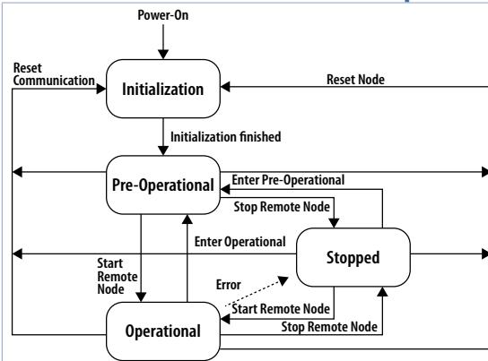
L'inizializzazione delle reti prevede due processi di boot-up: Minimum boot-up ed Extended boot-up. Il primo è un pre-requisito per un dispositivo CANopen, il secondo è opzionale, ma necessario se i COB-ID devono essere allocati dai servizi DBT. Il diagramma di transizione qui accanto, mostra una procedura di minimum boot-up per un nodo CANopen.
