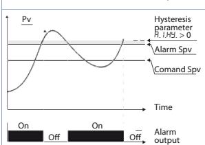
Allarme di deviazione inferiore valore di setpoint allarme minore di "0" e valore di isteresi maggiore di "0" (Par. 58 R.IH > 0). **NB:** con isteresi minore di "0" ( $R.IH < 0$ ) la linea tratteggiata si sposta sotto il Setpoint di allarme.
