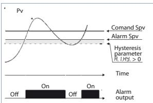
Allarme di deviazione superiore valore di setpoint allarme minore di "0" e valore di isteresi maggiore di "0" (Par. 58 R.IH > 0).
