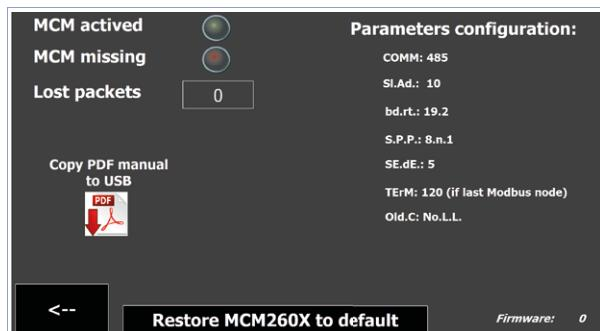
Nel caso di diagnostica di un modulo I/O MCM260X, la finestra mostra anche l'elenco dei parametri da inserire per la corretta impostazione del baudrate e del numero di slave.
