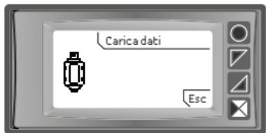
L'utente ha due possibilità, "Carica dati" per caricare i parametri dalla memory o "Esc" per annullare l'operazione senza modificare la configurazione attuale.
