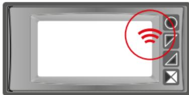
Posizione dell'antenna NFC / RFid alla quale avvicinare lo smartphone per la connessione e la successiva lettura / scrittura dei dati.
