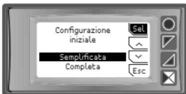
Una volta selezionata la lingua, lo strumento propone la possibilità di scegliere la modalità di configurazione che può essere semplificata o completa. Selezionando la prima si accede direttamente al parametro di selezione delle configurazioni pre-impostate Easy-Up, mentre scegliendo la seconda opzione si accede al menù di configurazione completo.
