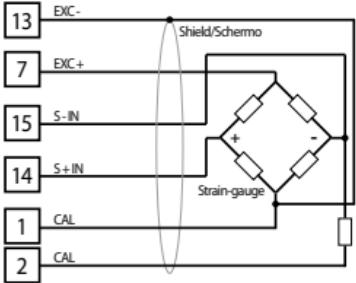
**Per sensori strain-gauge (4 fili + 2 fili calibrazione) o tasduttori di Melt.**
